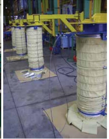
Gli scaricatori telescopici ZN sono usati per uno scarico efficiente di polveri o granuli in autocisterne e camion aperti.
